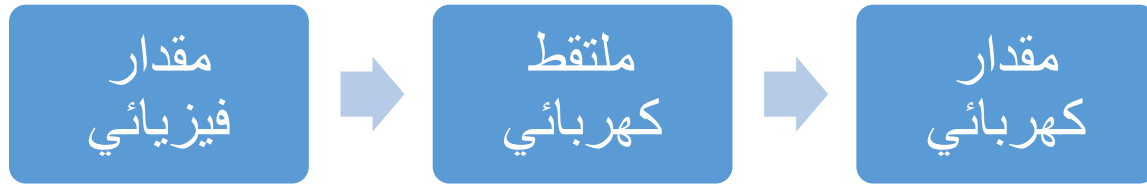
الشكل 1.2: مبدأ عمل الملتقطات الكهربائية.
