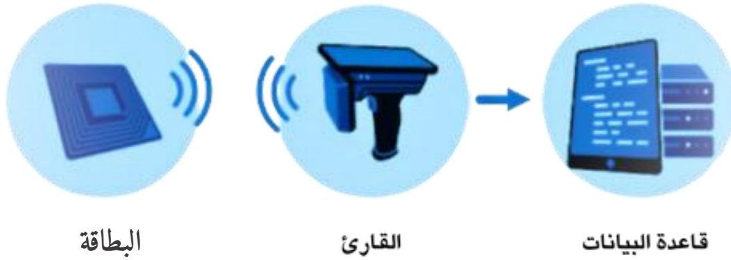
الشكل 9.2: اجزاء نظام RFID.
