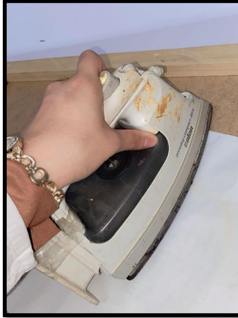
الشكل (11.III): الصاق المسارات باستعمال المكواة.
