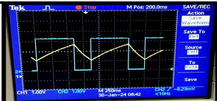
الشكل (II. 32): إشارة المدل مزامنة مع إشارة المخرج براسم الاهتزاز المهبطي.
