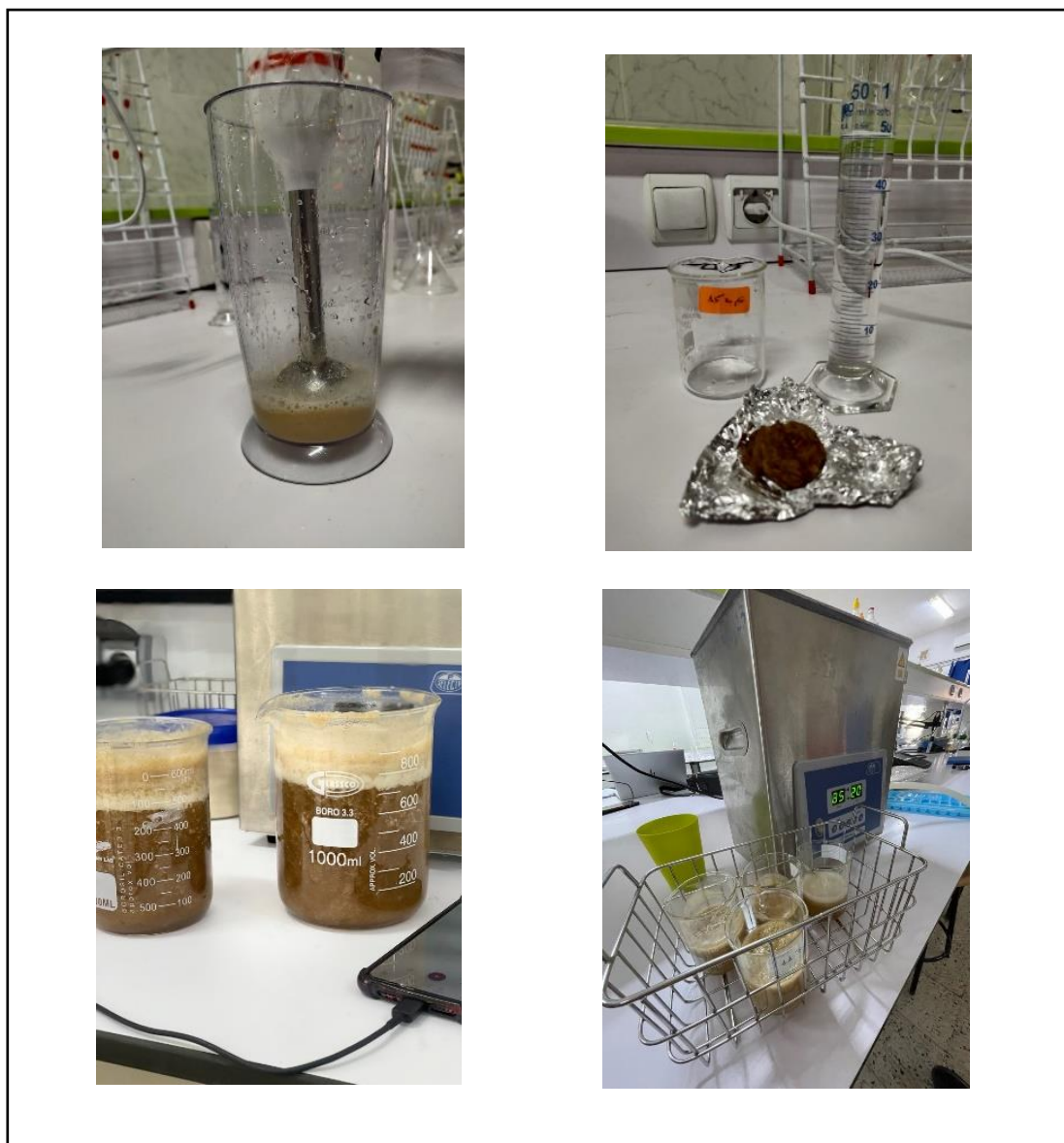
الشكل. IV. 3: مراحل عملية إستخلاص السكر من التمر منزوع النوى.
