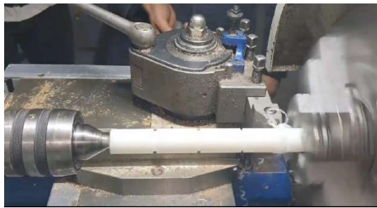
الشكل 19.iii. انجاز 5 مقاطع متطابقة
