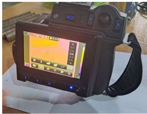
الشكل 15. III. كاميرا التقاط درجة الحرارة
