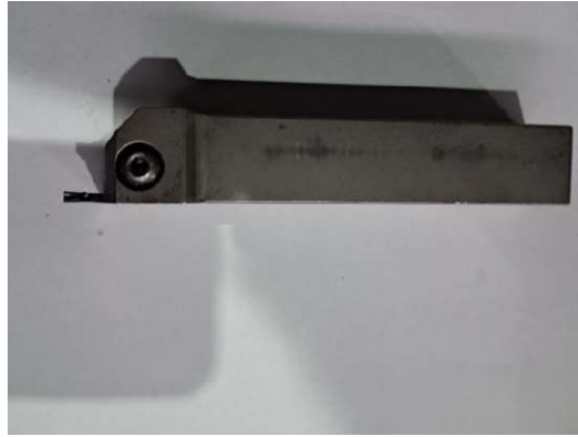
الشكل 8.III. أداة التعنيق
