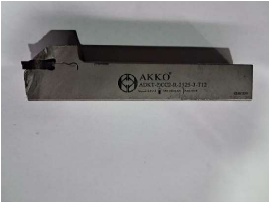
الشكل 9.III. تعيين أداة التعنيق
