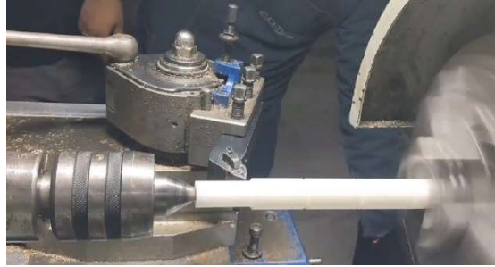
الشكل 20.iii. عملية الخراط الطولي
