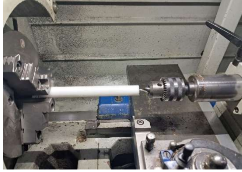
الشكل 17.iii. احداث ثقب تمرکز
