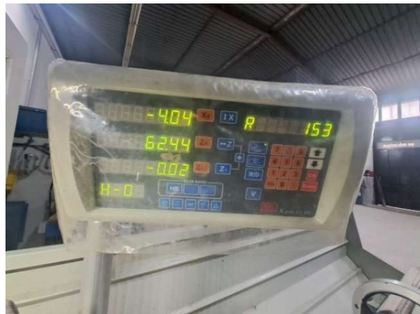
الشكل 5.111. شاشة عرض سرعة الدوران وإحداثيات أداة القطع
