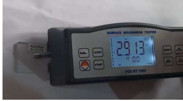
الشكل 21. III. ضبط مع التحقق من دقة القياس على المرجع
