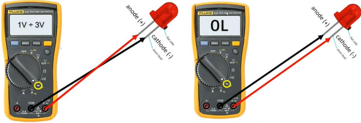
الشكل (25.II): اختبار صلاحية الثنائي الضوئي LED باستخدام متعدد القياسات
