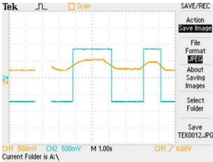
الشكل (IV. 25): نتائج تشخيص المقاومة الضوئية (LDR) في الطابق G باستعمال راسم الاهتزاز المهبطي
