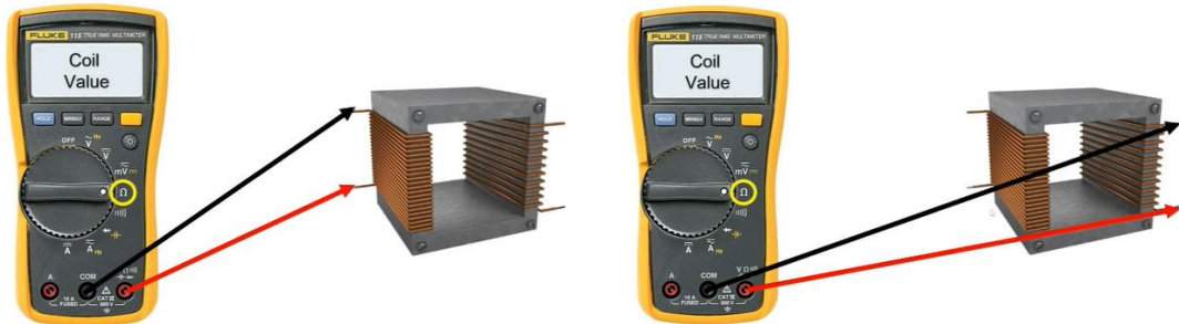
الشكل (22.II): اختبار صلاحية المحول الكهربائي باستخدام متعدد القياسات
