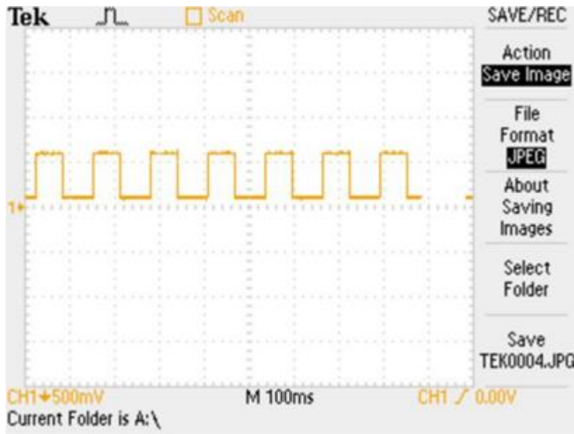
الشكل (IV. 21): نتائج تشخيص NE555 باستعمال راسم الاهتزاز المهبطي
