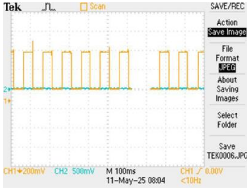
الشكل (IV. 19): نتائج تشخيص المكثفة باستعمال راسم الاهتزاز المهبطي
