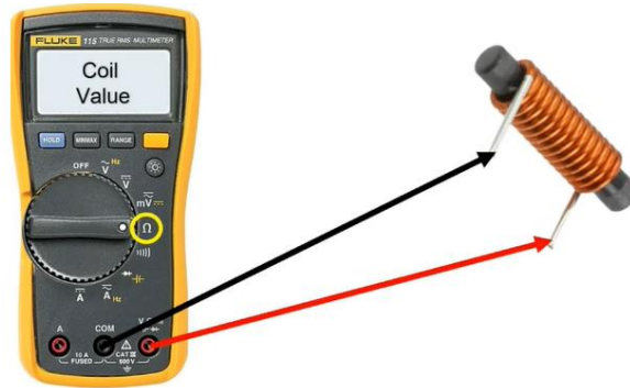
الشكل (21.II): اختبار صلاحية الوشيعة باستخدام متعدد القياسات
