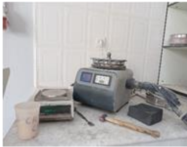
الشكل 6. جهاز ألبين مع ميزان ومنخل 45\mu\text{m} .
