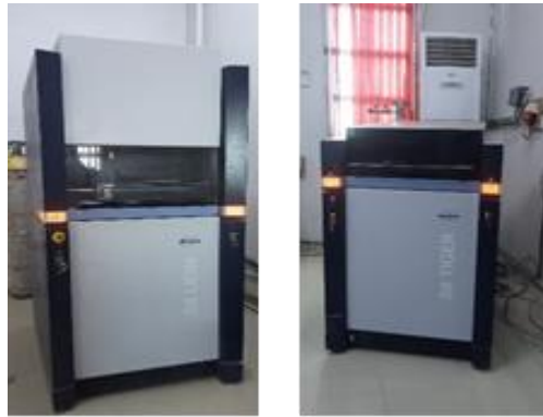
الشكل 1. جهاز مطيافية الأشعة السينية فليوريسونس XRF من العلامة BRUKER النوع S8 LION.
