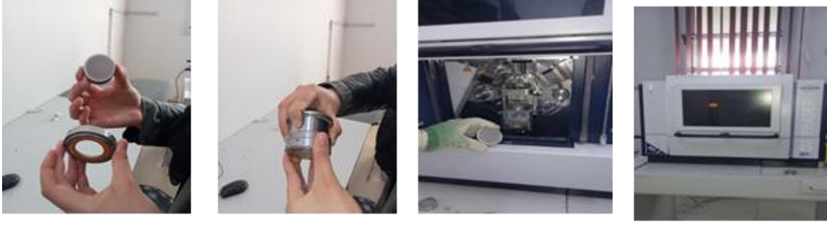
الشكل 5. جهاز حيود الأشعة السينية XRD من العلامة BRUKER النوع D2PHASER.
