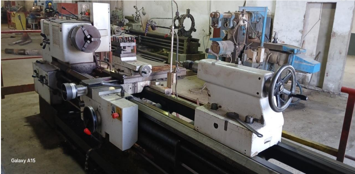
الشكل.2. 1 صورة توضيحية لآلة الخراطة التي أجريت عليها الأبحاث.
