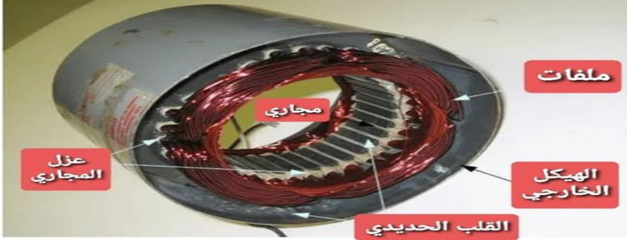
الشكل ( I .21): أجزاء العضو الساكن
