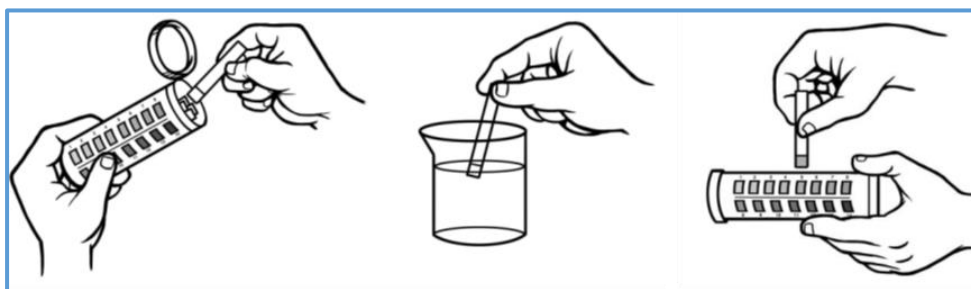
الشكل II.3. استخدام شريط الاختبار لقياس الملوثات الكيميائية. (CAWST, 2013, pp. 6.5-6.6)
