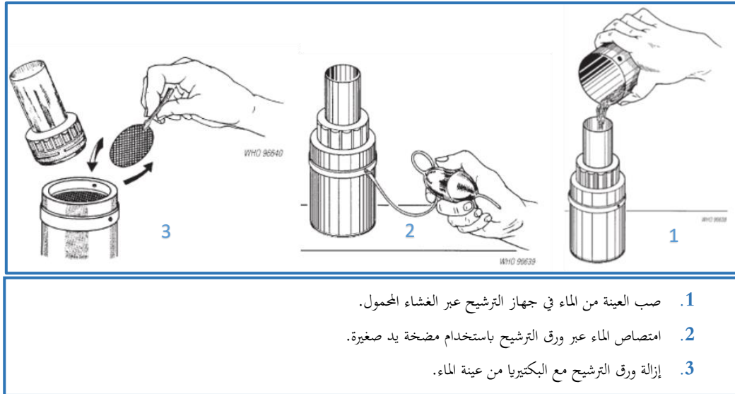
الشكل II.5. طريقة الترشيح عبر الغشاء لتحليل جودة المياه. (CAWST, 2013)
