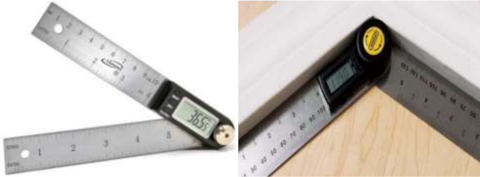
شكل 86: استعمال محدد قياس الزوايا الرقمية.
