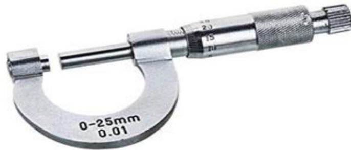
شكل 46: مجال قياس ميكرومتر هو 25 مم ودقته هي 0.01 مم.
