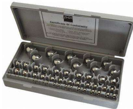
شكل 106: محددات قياس كروية لقياس السلبة المروية.
