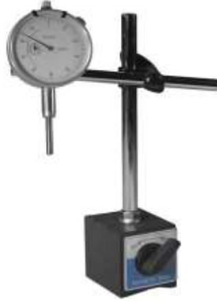
شكل 110: تثبيت ساعة القياس على قاعدة قياس مغناطيسية مستوية.
