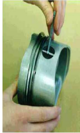
شكل 73: مثال باستعمال المحدد التلسكوبي
