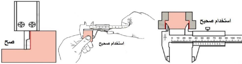
شكل 42: الاستخدام الصحيح عند إجراء عملية القياس.
