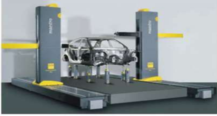
شكل132: جهاز فحص لألة القياس ثلاثية الأبعاد.
