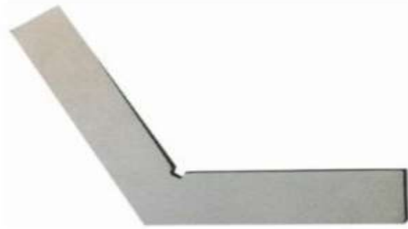
شكل 85 : محدد قياس زاوية منفرجة 120
