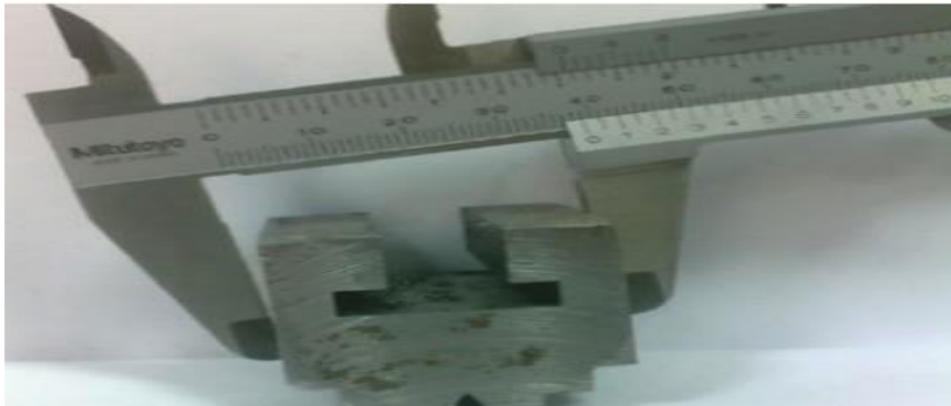
شكل 40: خطأ ميل القدمة عند إجراء عملية القياس.
