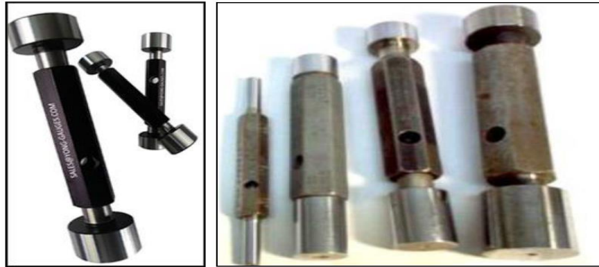
شكل 65: محددات القياس السدادية
