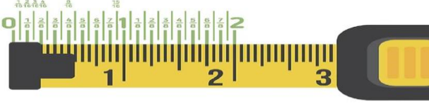
شكل 17: تدريج المتر Tape بالبوصة في النظام الإنجليزي
