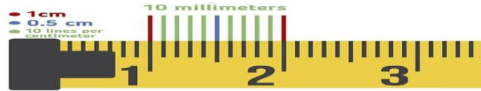
شكل 16: تدرج المتر Tape بالسنتيمتر في النظام الدولي المتري
