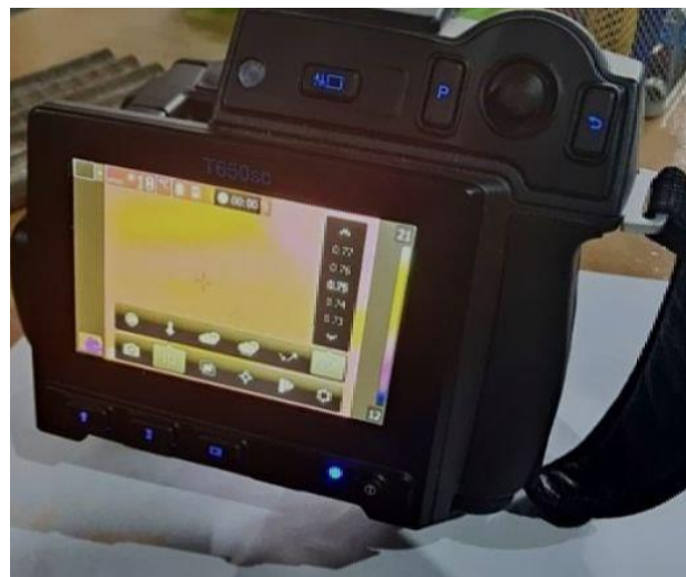
الشكل 12.3: كاميرا التقاط درجة الحرارة.
