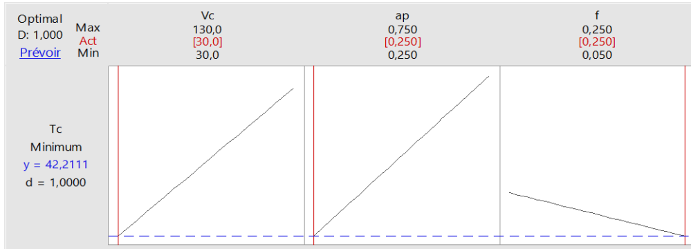
الشكل 4.4: مخطط تحسين الاستجابة لدرجة الحرارة (Tc).
