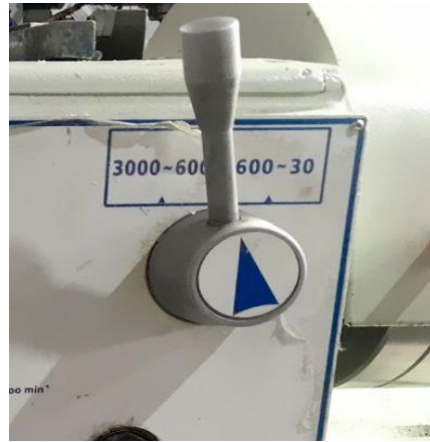
الشكل 3.3: مقبض اختيار سرعة الدوران.
