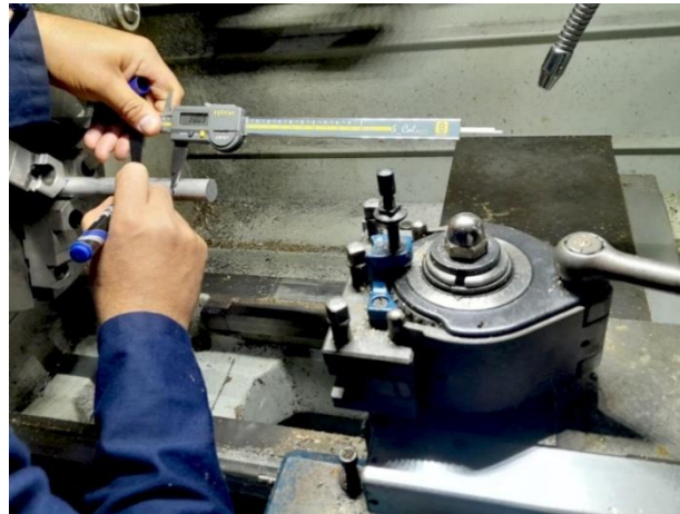
الشكل 13.3: عملة قياس الطول.
