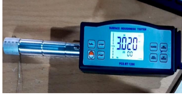
الشكل 19.3: عملية قياس الخشونة.
