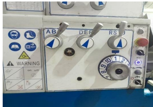
الشكل 5.3: مقابض التحكم في سرعة التغذية.
