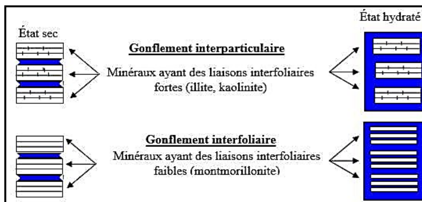
Figure I.11 Mécanismes de gonflement des argiles par hydratation.
