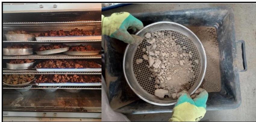
Figure III.6 Préparation de l'échantillon.
