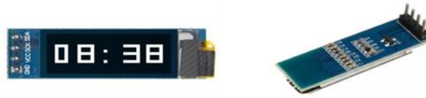
الشكل 2-8: الشاشة OLED مقاس 0.91 بوصة مقاس 32 \times 128 [34]
