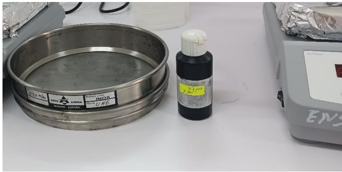
الشكل (III.8): عملية غربلة فحم الكوك المطحون .
