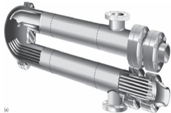
الشكل 6.1: مبادل حراري من نوع الأنبوب المزدوج. [6]
