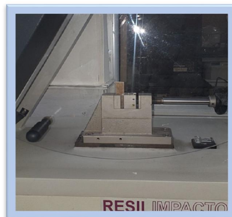
Figure II. 9: Appareillage pour le calcul de la résilience selon l'essai IZOD [60].
