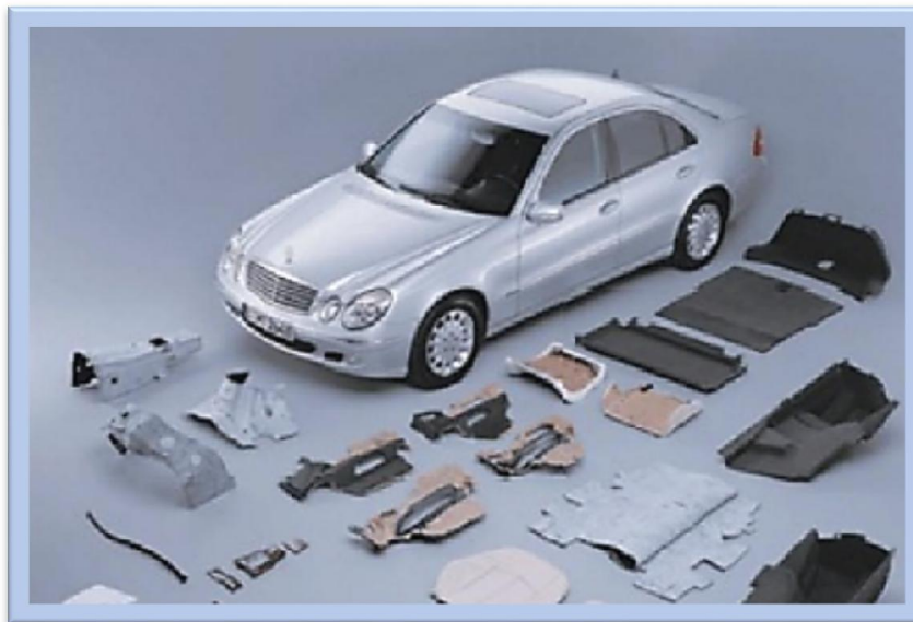
Figure I. 36: Composants d'automobile en composites de fibres végétales [57].
