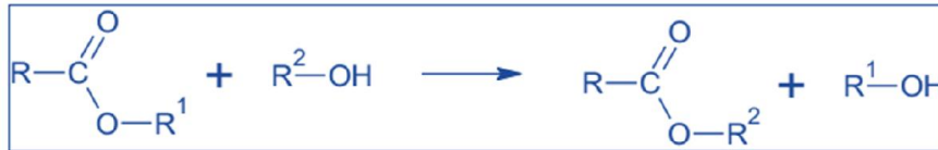
Figure I. 9: Réaction de transestérification[23].
