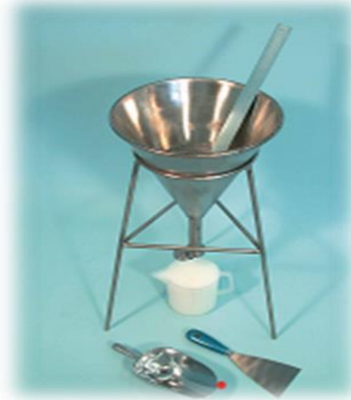
Figure III- 19 : l'essai masse volumique apparente d'un ciment.
