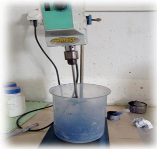
Figure III- 17:L'essai au bleu de méthylène [LTPE, 2024]
