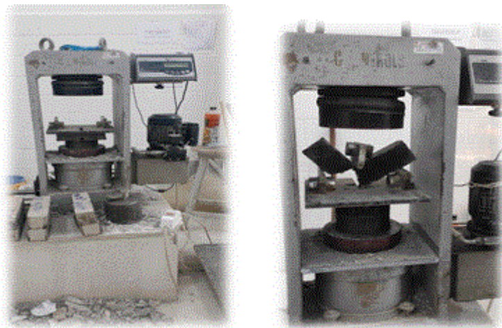
Figure III- 25: Essai de traction par flexion [LTPE, 2024]
