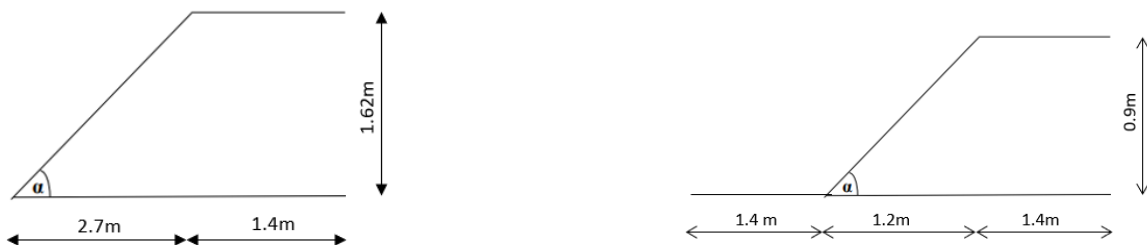
Figure III.11 : Schéma statique des escaliers (2 volées) et (3 volées).
