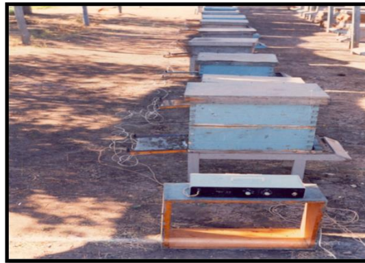
الشكل 41: صورة توضح نظام تشغيل 40 لوحة استقبال على 40 طائفة في وقت واحد (24)
