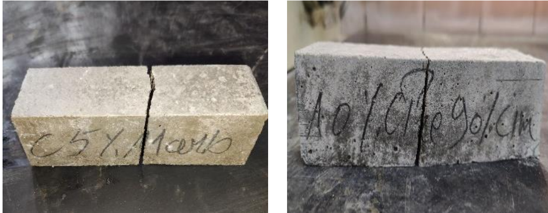
Figure III.14. Mode de rupture des éprouvettes en flexion de mortier mixte additionné de poudre de marbre.
