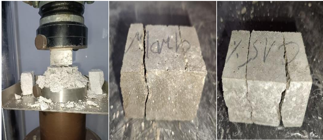
Figure III.15. Mode de rupture des éprouvettes en compression de mixte et mortier témoin.
