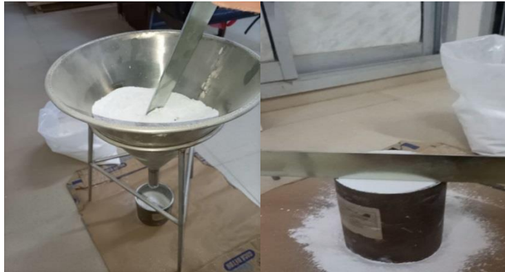
Figure II.12. Essai de la masse volumique apparente.
