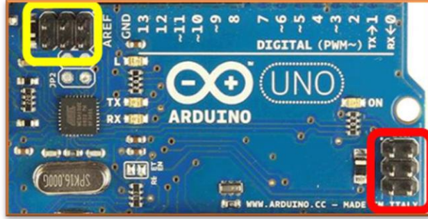
الشكل II.22: منفذ برمجة ICSP للميكرو مراقب ATmega16U2 المحاط باللون الأحمر، منفذ برمجة ICSP للميكرو كونت ATmega 328P المحاط باللون الأصفر.
