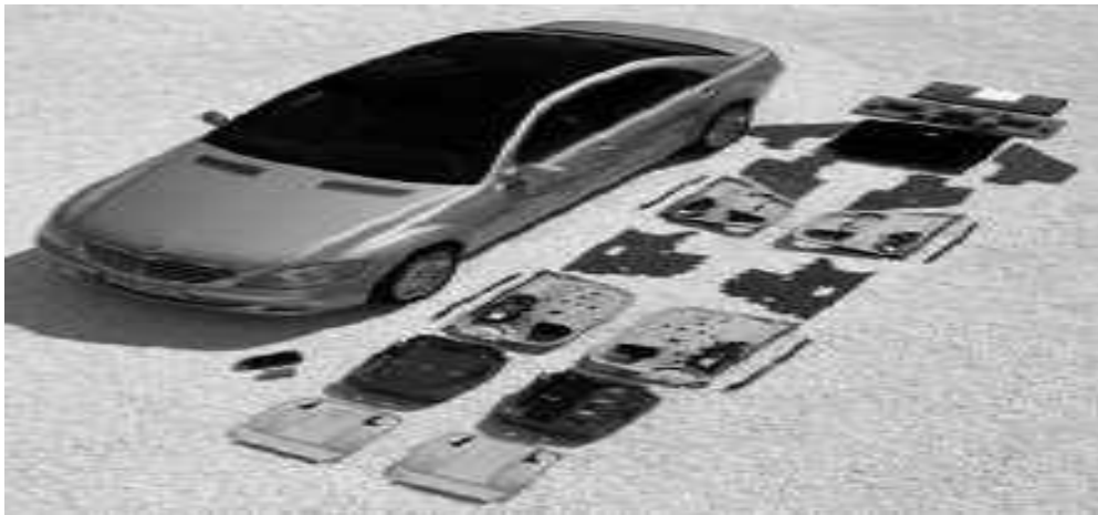
Figure II.11 : Pièces de Mercedes Classe S fabriquées à partir de différents matériaux composites renforcés de fibres naturelles [51].
