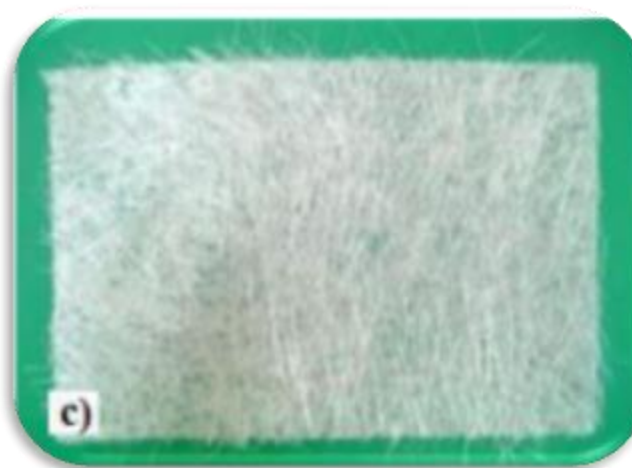
Figure I .6 : les différentes formes des renforts fibres de verre. [1]
