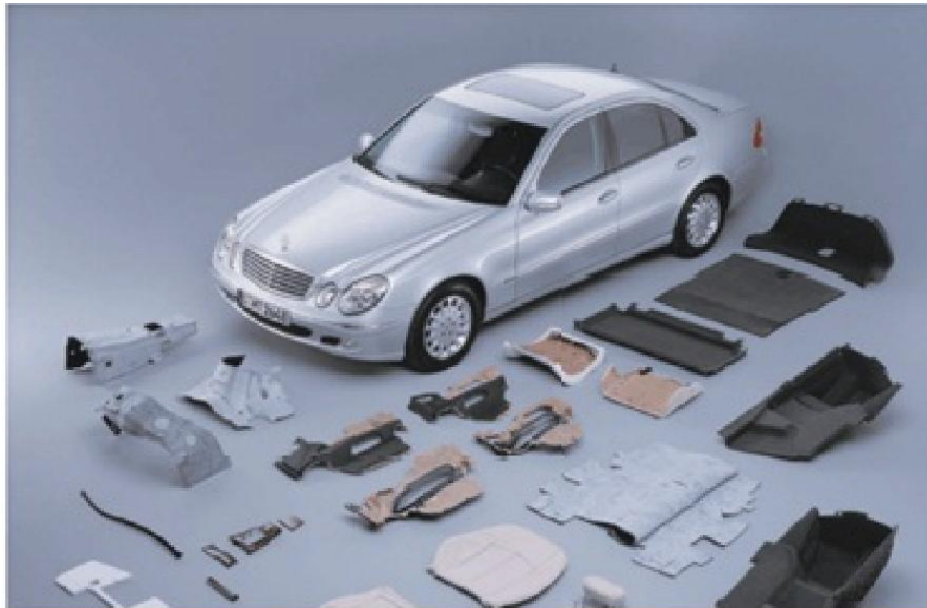
Figure I.16 : Composants d'automobile en composites de fibres végétales [15].
