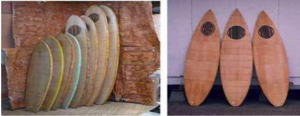
Figure II.14 : Planches à base de fibre de bambou [53]
