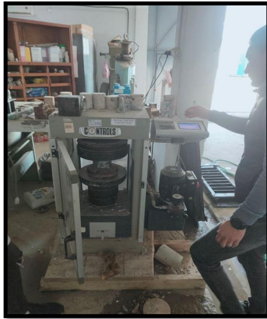
Figure II-23 : : Essais de compression à l'état durci.
