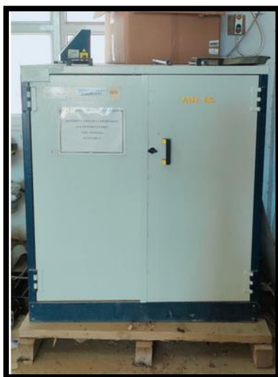
Figure II-21 : machine de Essai Los Angeles.
