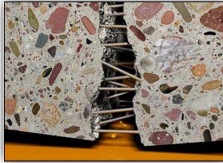
Figure 5 : Exemple du béton de fibres[19].
