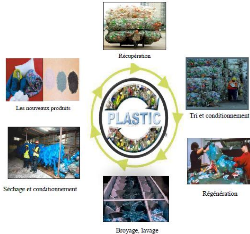
Schéma 7 : Processus de recyclage mécanique des déchets plastiques.
