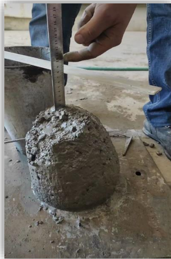
Figure 51 : Affaissement au cône d'Abram [LTPE,2024].
