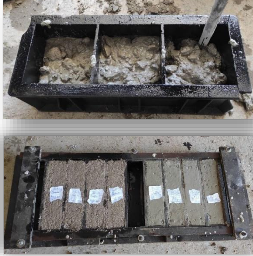
Figure 52 : Remplissage des moules et mode de mise en place [LTPE ,2024].
