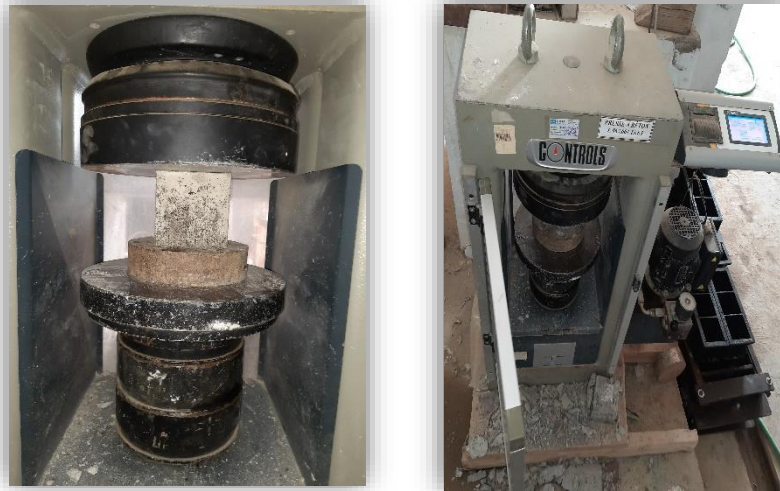
Figure 54 : Essai de résistance à la compression [LTPE,2024].
