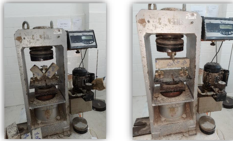
Figure 55 : Essai de rupture par flexion (la traction) [LNHC,2024].
