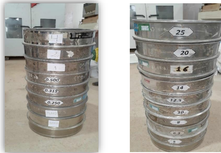
Figure 34 : Tamis d'analyse granulométrique de sable et gravier [LTPE,2024].
