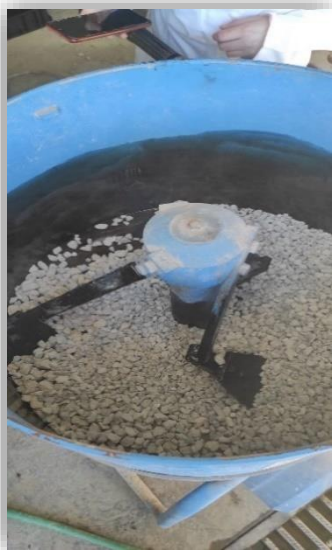
Figure 50 : Malaxage de béton [LTPE,2024].
