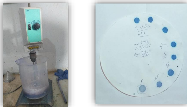
Figure 44 : L'essai au bleu de méthylène [LTPE,2024].
