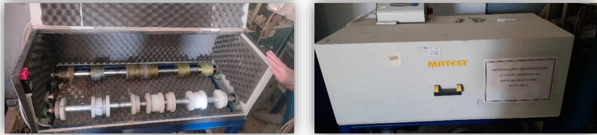
Figure 42 : Résistance a l'usure : essai micro-Deval [LTPE,2024].
