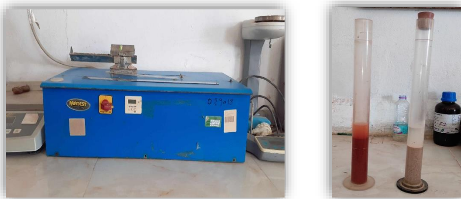
Figure 43 : L'essai Équivalent de sable [LTPE,2024].
