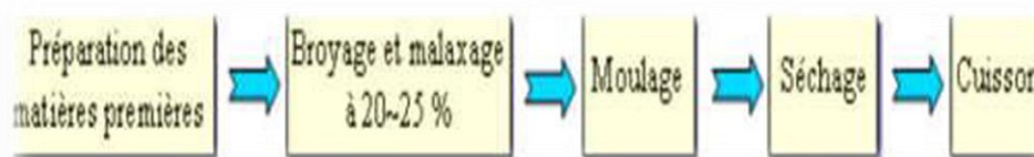
Schéma 2 : Fabrication des briques [14].
