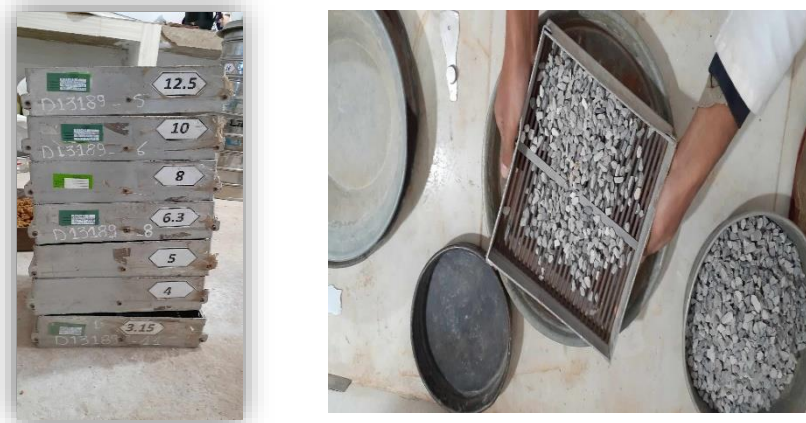
Figure 39 : L'essai d'aplatissement des granules [LTPE,2024].
