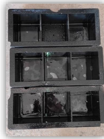
Figure 47 : Préparation des moules [LTPE, 2024].
