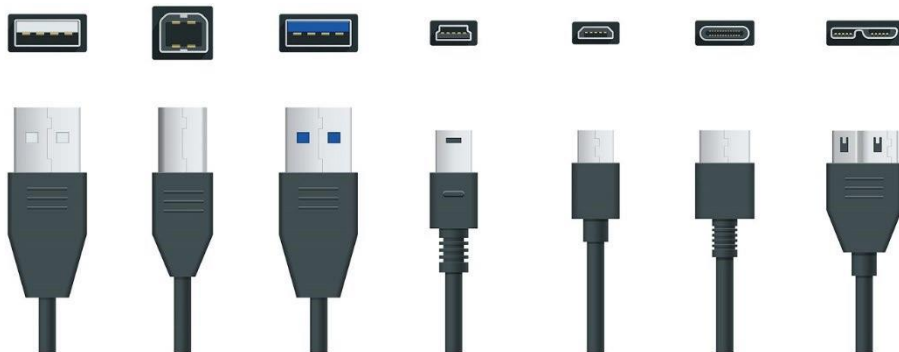
USB Type A USB Type B USB 3.0 USB Mini USB Micro USB Type C USB Micro B
