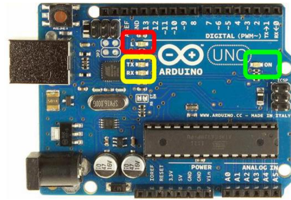
الشكل (13.ii): الثنائي الضوئي ON محاط بمربع أخضر، الثنائي الضوئي L محاط بمربع أحمر، الثنائي الضوئي TX,RX محاطان بمربع أصفر.
