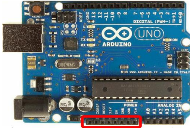
الشكل (19.II): منافذ الاستطاعة من اليمين الى اليسار، RESET، 3.3 V، 5V، GND، GND، VIN و IOREF ومنفذ غير مستخدم.
