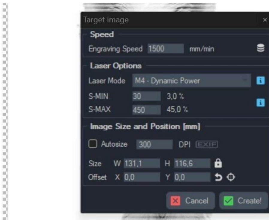
الشكل (6.IV): ضبط إعدادات الليزر.
