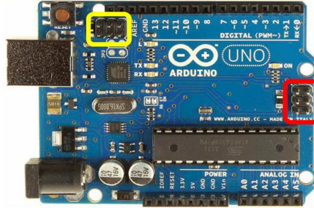
الشكل (18.II): منفذ برجة ICSP للتحكم ATmega328 محاط بالأحمر، ومنفذ برجة ICSP للتحكم ATmega16U2 محاط بالأصفر.
