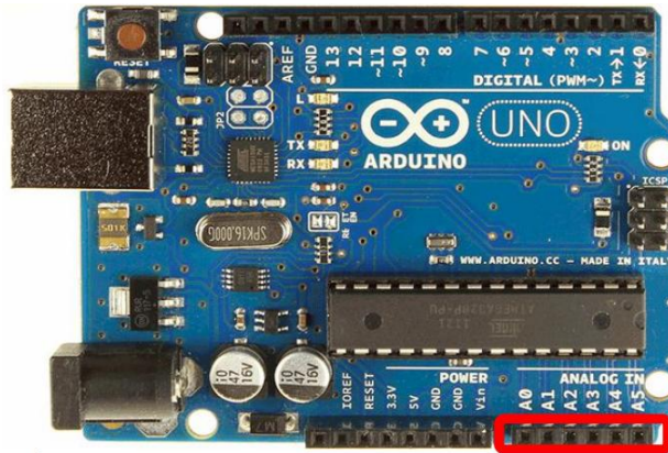
الشكل (20.II): المداخل التماثلية الستة في لوحة الأردوينو أونو.
