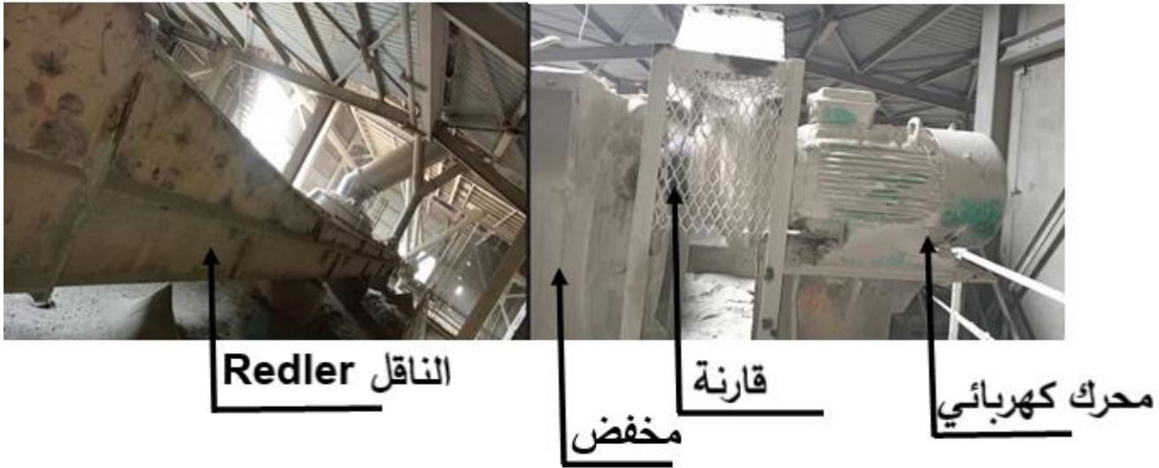
شكل 3.IV: جهاز ناقل الاسمنت Redler.
