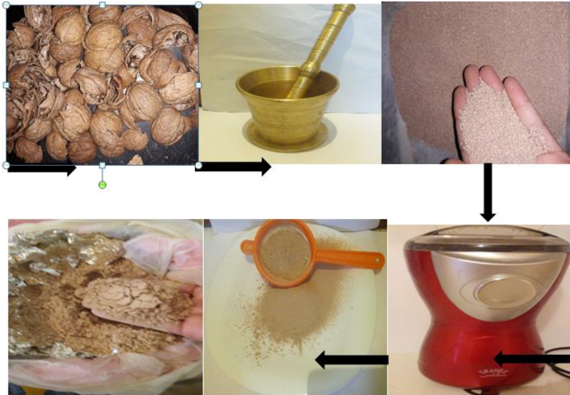
Figure IV-2. Les étapes de la préparation de poudre de coquille de noix
