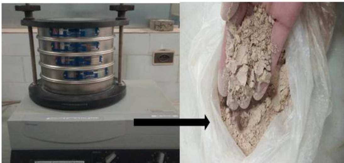
Figure IV-3. L'opération de tamisage avec une tamiseuse (AS200 basic)
