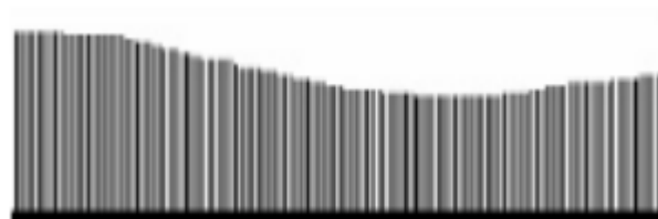
Figure II.4 : Modèle de fluctuation Swerling III.
