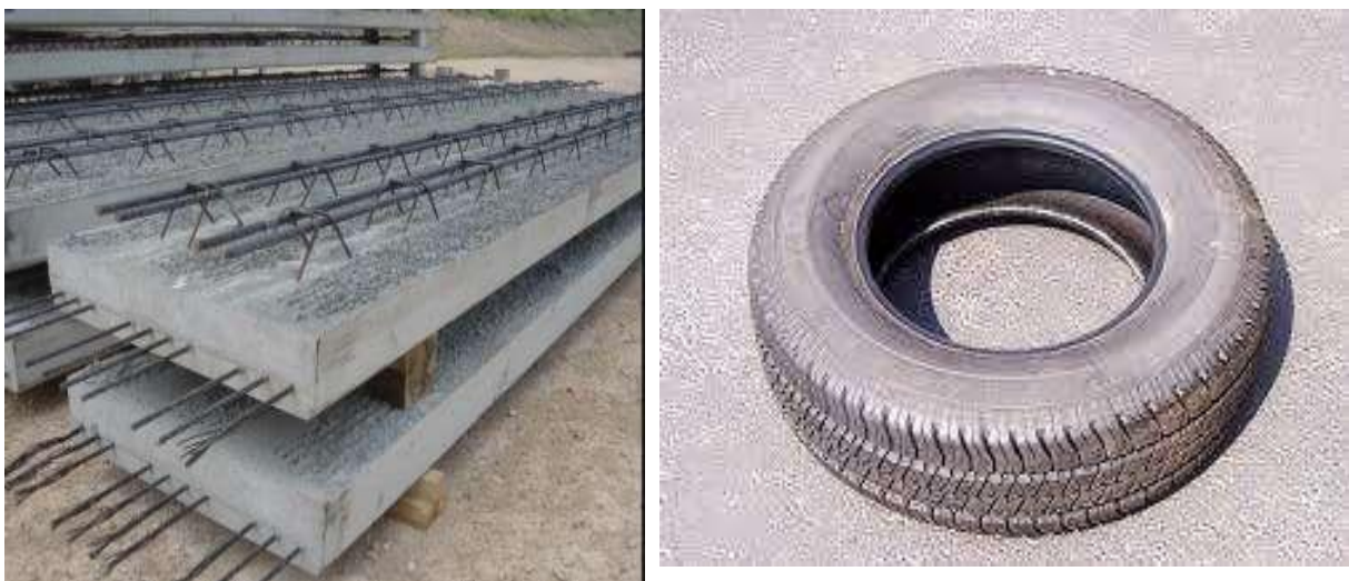
Figure. I. 5. Béton armé (béton + armature acier), pneumatiques (élastomère + toile + fils d'acier)
