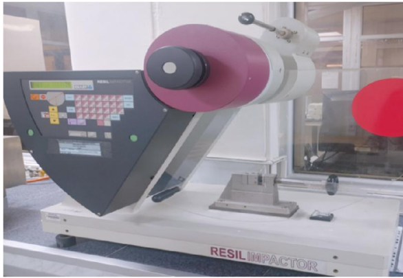
Figure III. 8 : Appareillage pour le calcul de la résilience selon l'essai IZOD [44].
