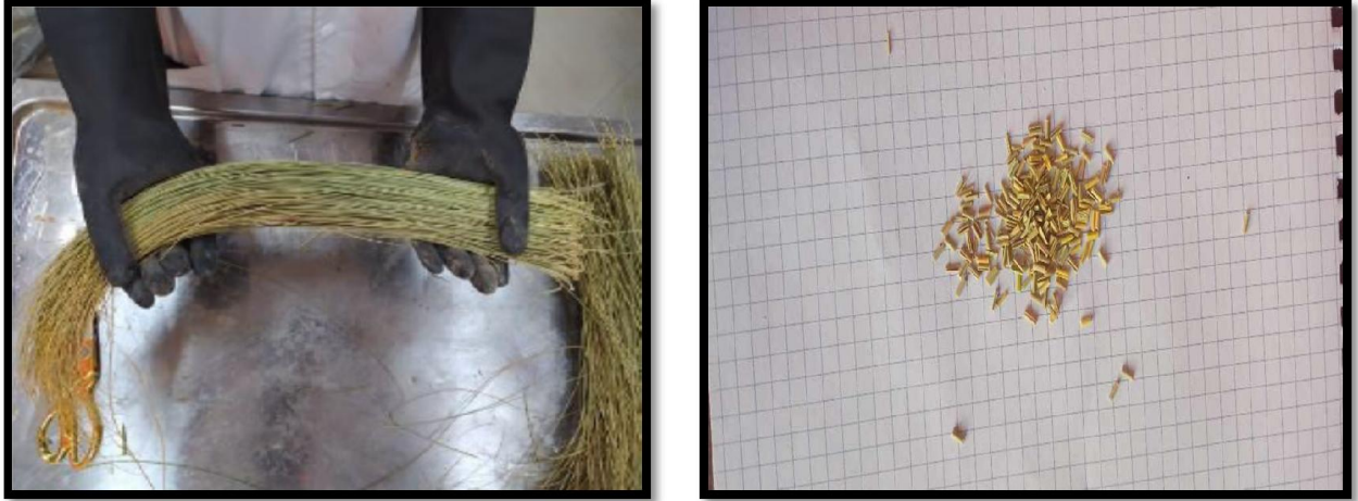
Figure III. 3 : Découpage les fibres d'Alfa en longueur de 3mm.
