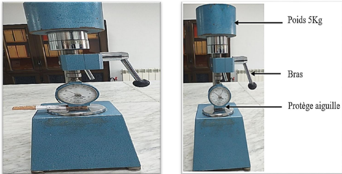
Figure III. 10: Appareillage de mesure de la dureté Shore D.
