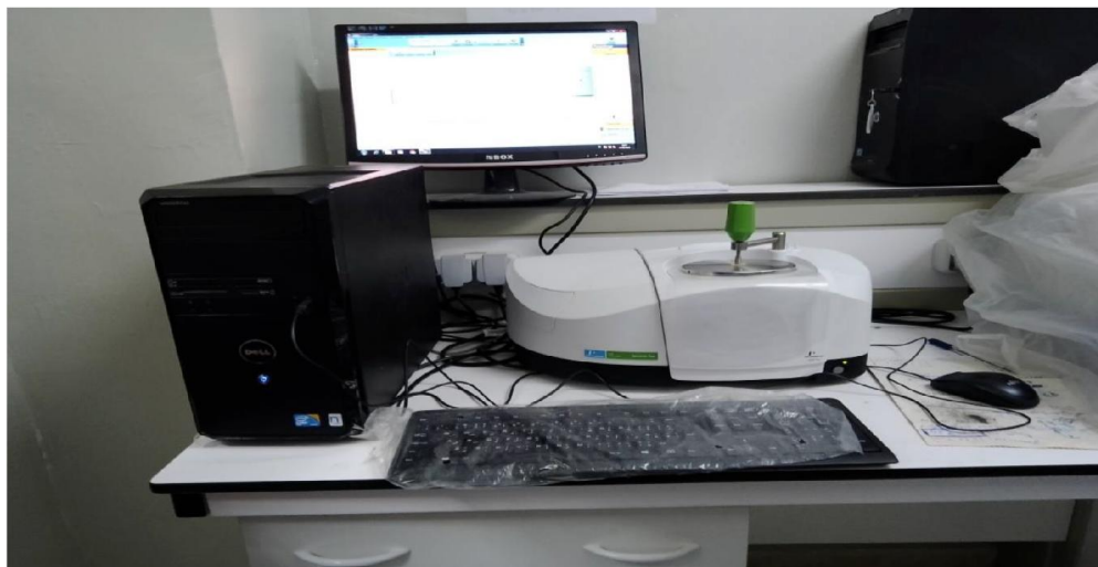
Figure III. 13: Spectrophotomètre à transformée de Fourier de type Perkin Elmer FT-IR spectromètre.
