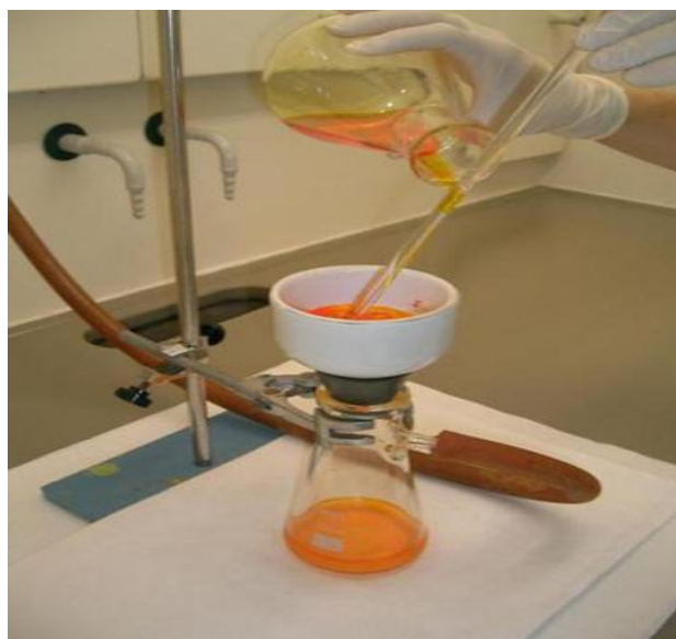
Figure II.3 : principe des méthodes gravimétriques par précipitation
