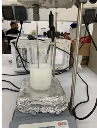
الشكل 09: جهاز محاكاة الغسالة (خلاط ميكانيكي).
