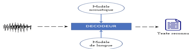
Figure1. 2 :Architecture classique (et hybride) d'un Système de Reconnaissance Automatique de la Parole (SRAP)[43].
