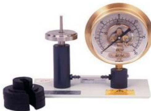
FIG. 3.9 – Manomètre type bourdon
