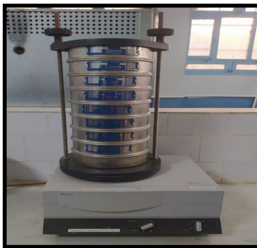
Figure IV-3 : opération de tamisage avec une tamiseuse d'analyse (AS200 basic).
