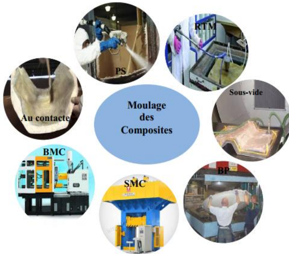
Figure III-16. Quelques procédés de mise en œuvre des composites.
