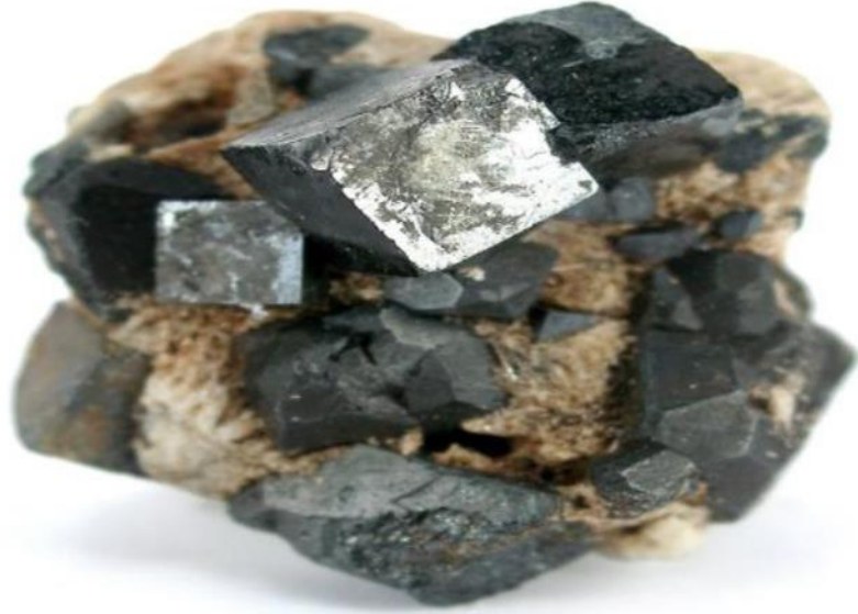
الشكل (1.1): بيروفسكايت تيتانات الكالسيوم \text{CaTiO}_3
