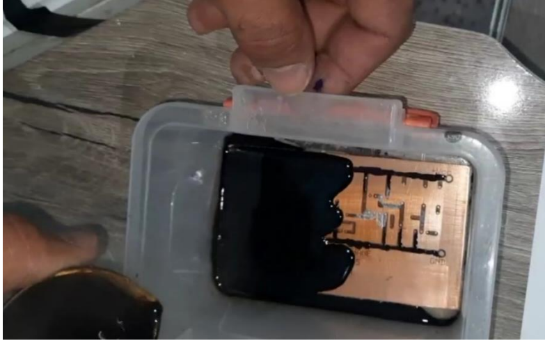
الشكل (25.IV): وضع لوح PCB في إناء بلاستيكي و غمره بالمحلول
