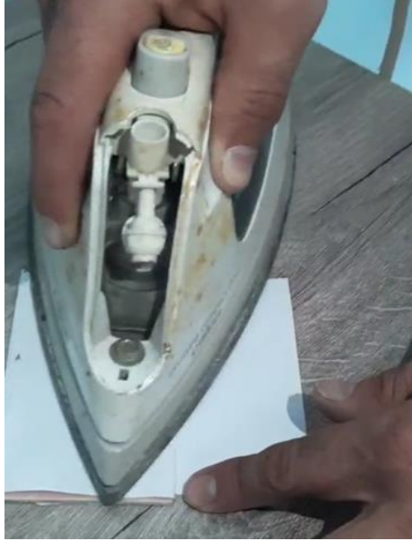
الشكل(22.IV): تثبيت المسارات على لوح PCB بواسطة المكواة
