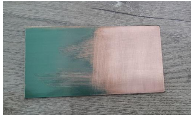
الشكل(20.IV): إزالة تأكسد الجهة النحاسية من لوح PCB .
