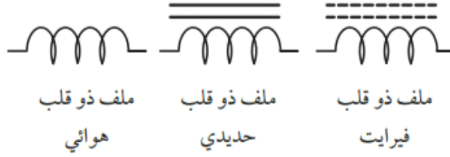
الشكل (9.I): يوضح بعض أنواع الوشائع.
