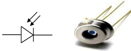
الشكل (3.II): رمز وشكل الصمام الضوئي.
