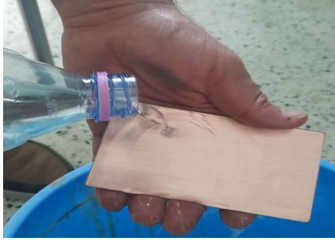
الشكل(21.IV): غسل لوح PCB .
