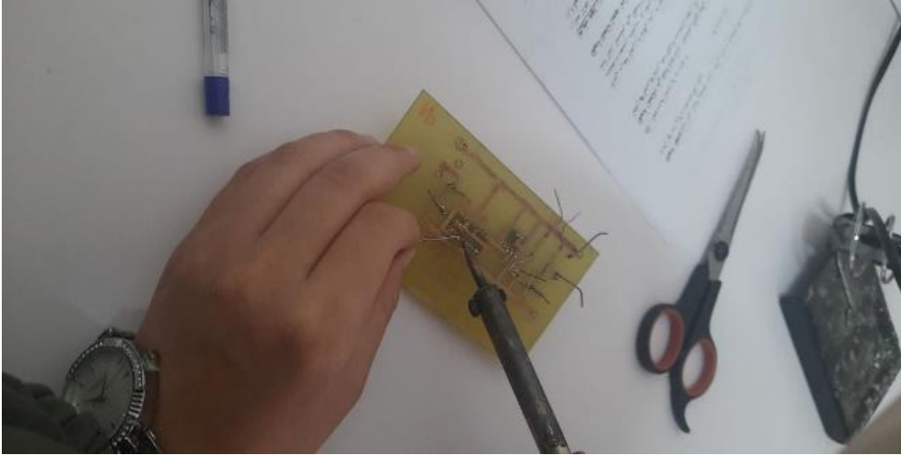
الشكل (28.IV): صورة عملية التلحيم
