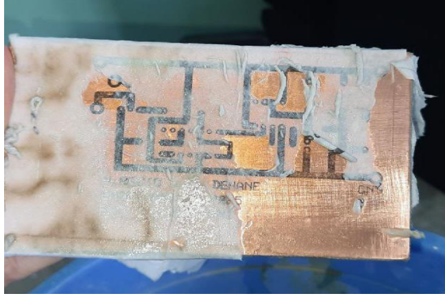
الشكل(23.IV): إزالة ورق الطباعة من لوح PCB بعد تثبيت المسارات
