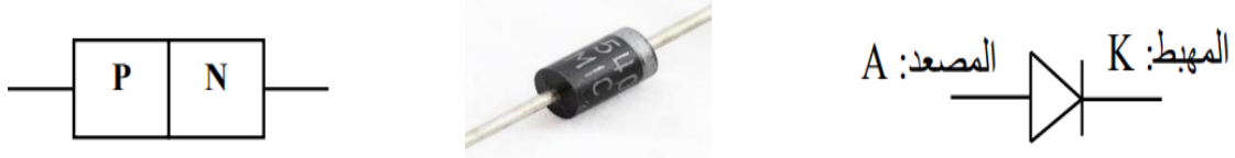
الشكل (2.I): يوضح شكل ورمز الصمام الثنائي.
