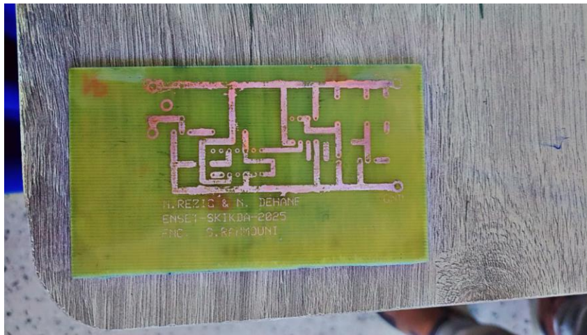
الشكل (26.IV): لوح PCB بعد إظهار المسارات.
