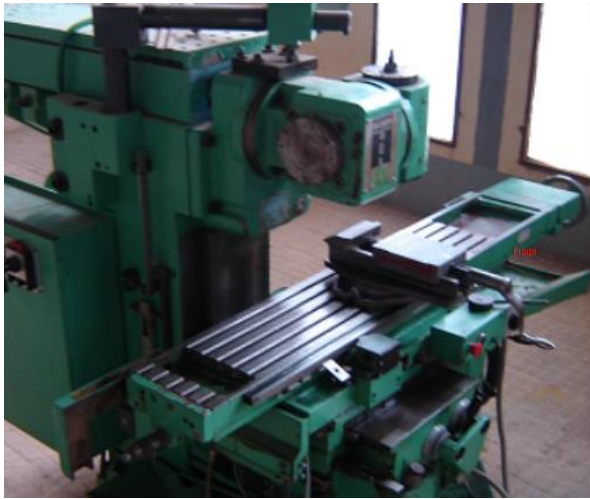
الشكل. III. 3b : تشغيل الأسطح المستوية للعينات. الشكل. III. 3a : آلة التفريز المستخدمة (آلة تفريز شاقولية).
