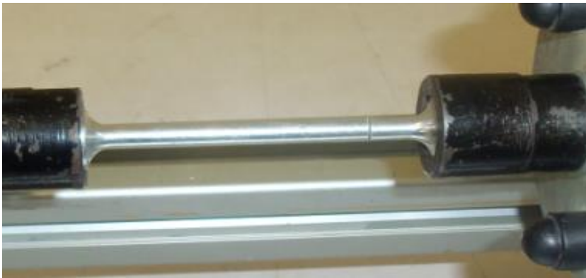
الشكل. III.9: عينة عند الكسر.
