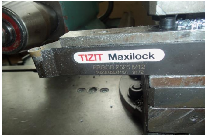
الشكل. III.6: اللقم وحاملات الأدوات المستخدمة.
