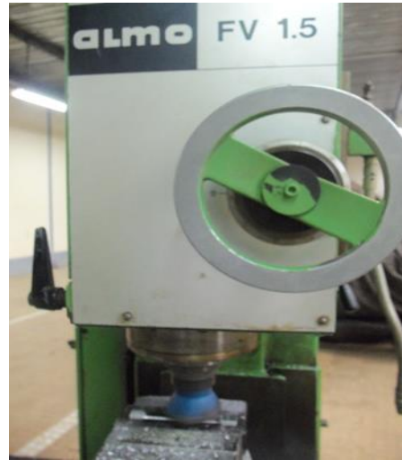
الشكل. III. 3b : تشغيل الأسطح المستوية للعينات. الشكل. III. 3a : آلة التفريز المستخدمة (آلة تفريز شاقولية).
