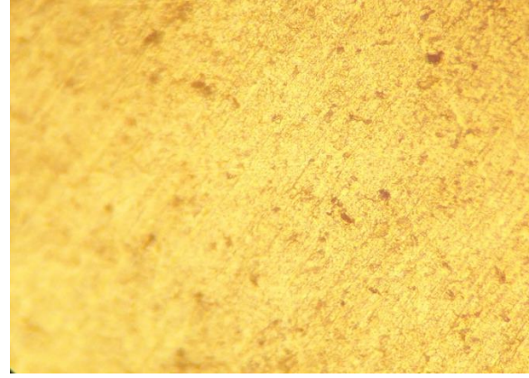
الشكل. 15b.IV: عينة صلبة مشوهة إلى 33% (centre zoom X40)
