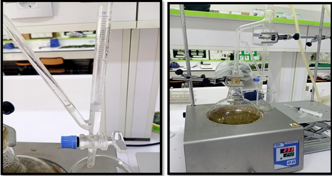
الشكل 15: جهاز كلفنجر المستعمل في عملية التقطير المائي (10 ديسمبر 2024)
