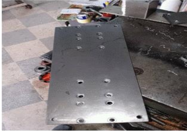
Figure II.6 : Usinage de la plateforme.
