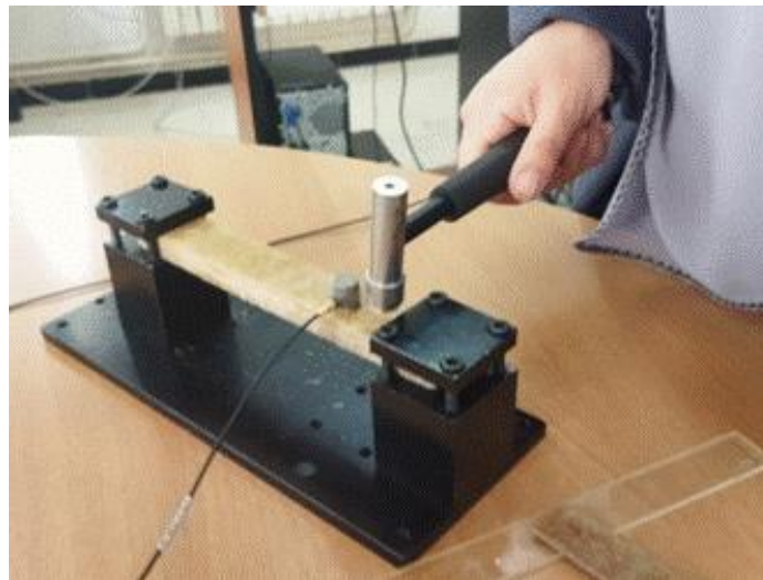
Figure II.15: Analyse vibratoire en montage encastré-encastré.
