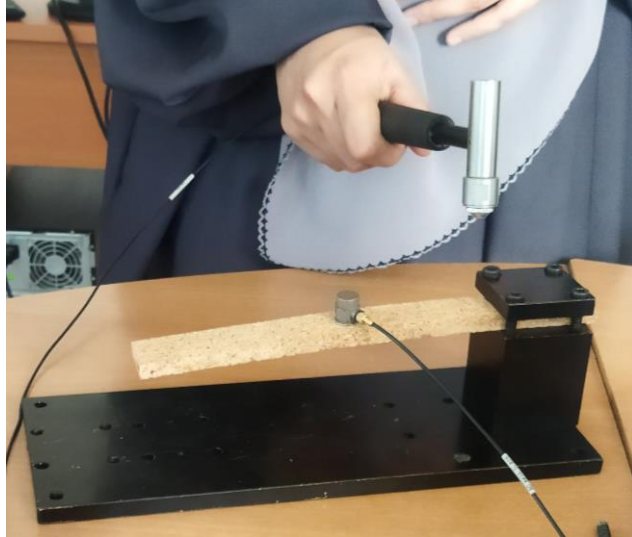
Figure II.16: Analyse vibratoire en montage encasté-libre.
