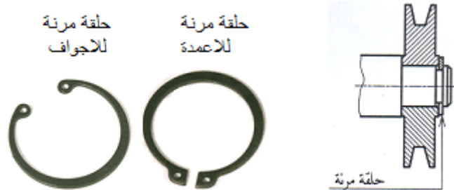
شكل 12.5 : تركيب حلقة مرنة لعمود .
