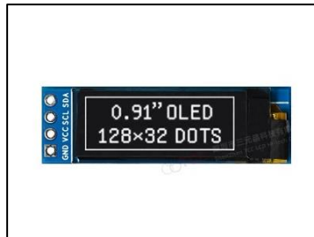
الشكل (3.3): شاشة OLED "0,91"
