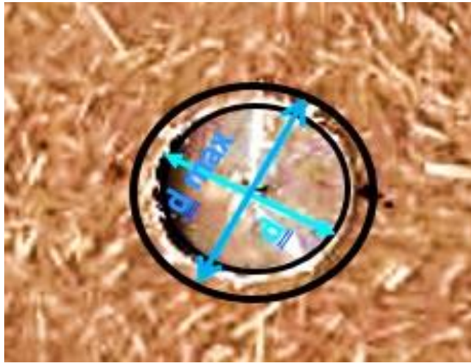
Figure II.12 : Zone de délaminage entre le diamètre nominal et le diamètre maximal
