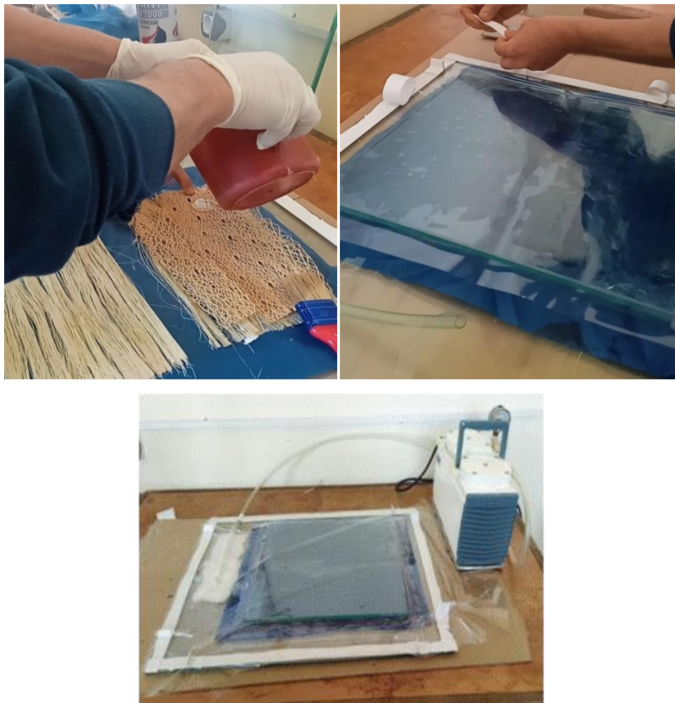
Figure II.6 : Etapes de préparation des plaques composites stratifiées par la technique du sac.
