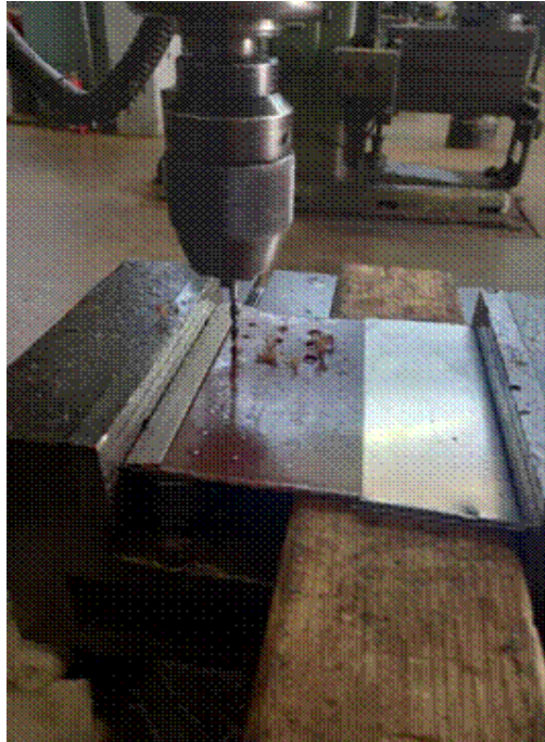
Figure II.10: Processus de perçage des plaques stratifiées
