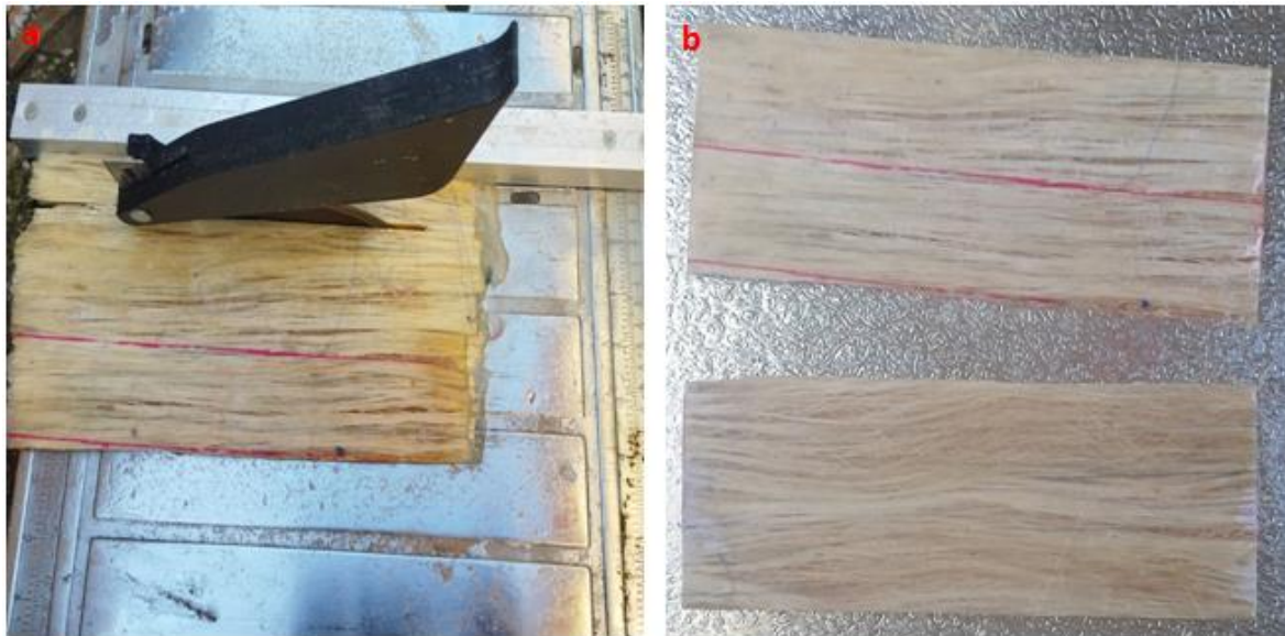
Figure II.7: a) Tronçonneuse à disque en diamant et b) Plaques composite obtenues
