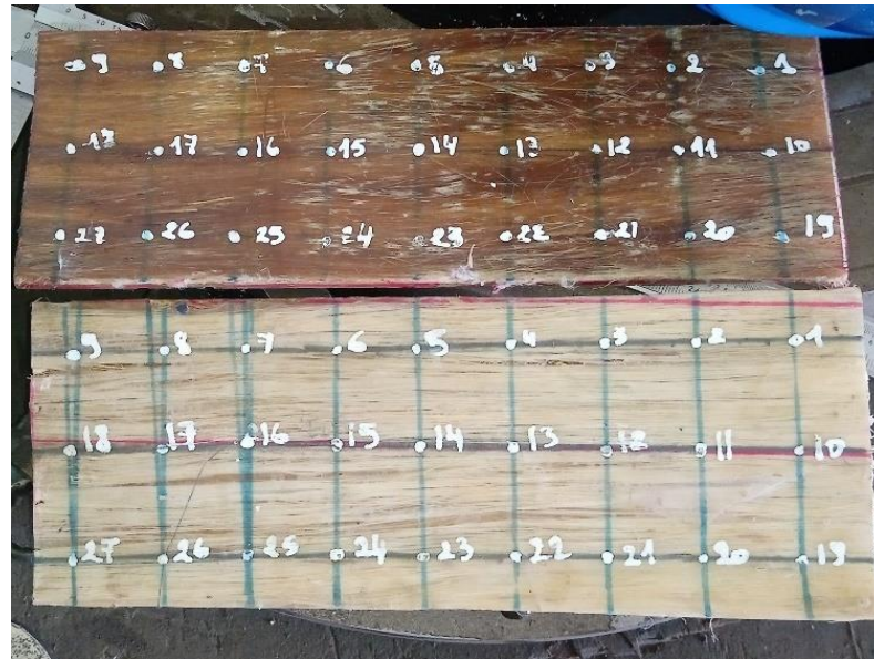
Figure II.8 : Traçage des plaques pour perçage
