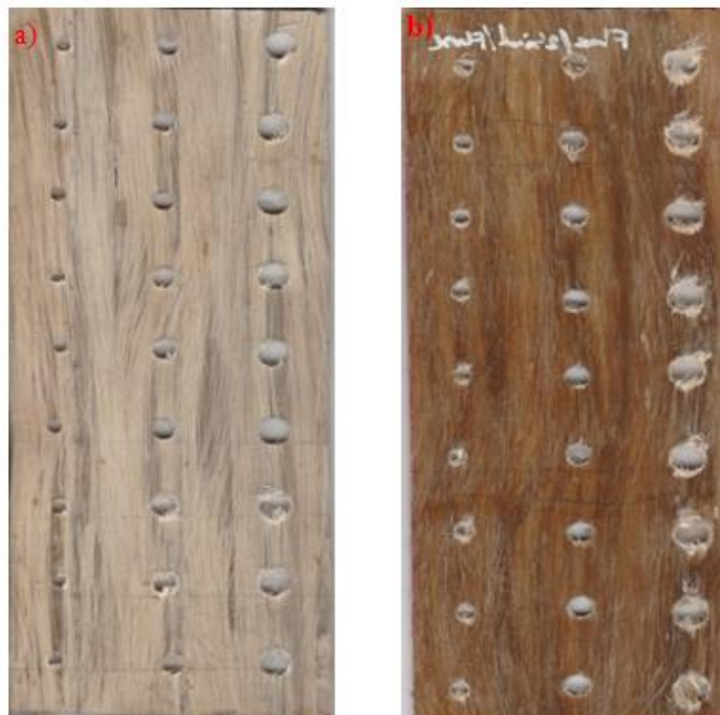
Figure III.10 : Observation du délaminage : a) matériau 1 et b) matériau 2
