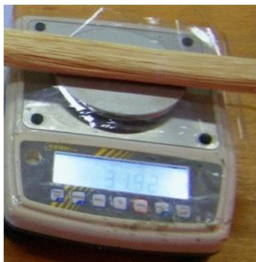
Figure II.5 : Opération de pesage des plis
