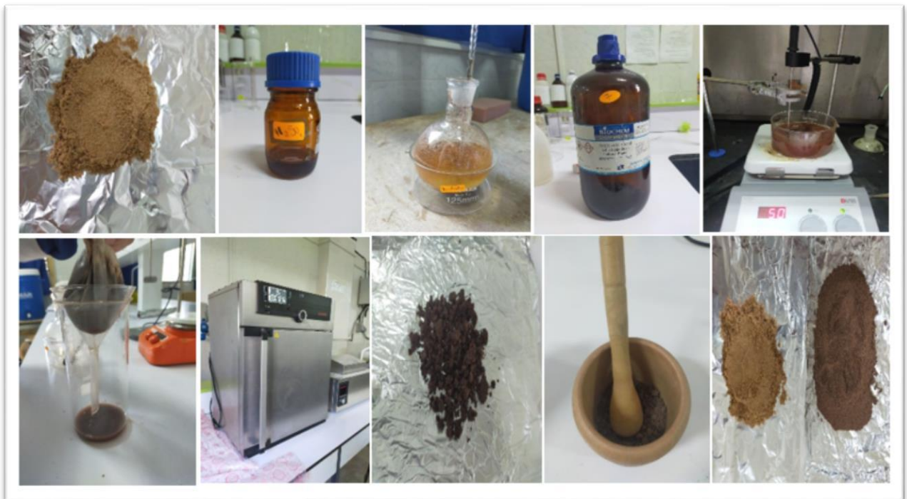
Figure II.4: Installation du traitement chimique de la FND.
