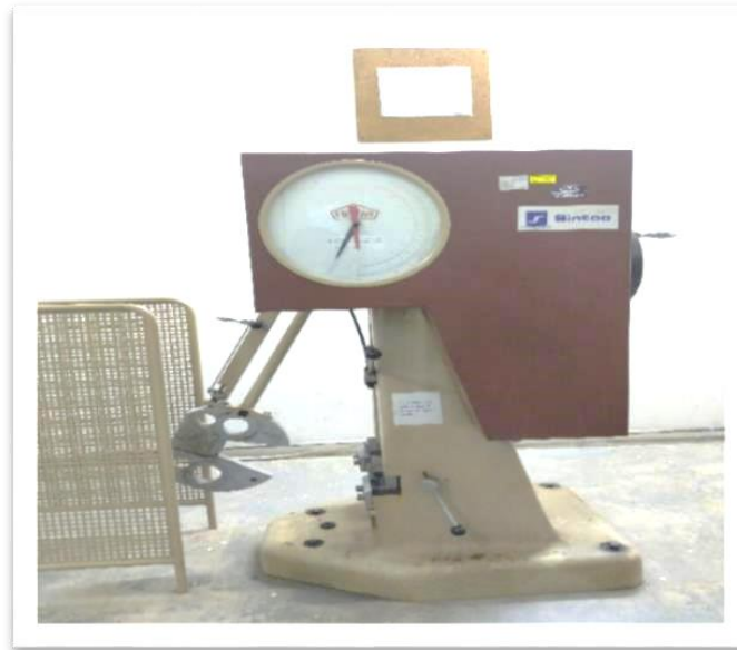
Figure II.8: Appareillage pour l'essai de la résilience.
