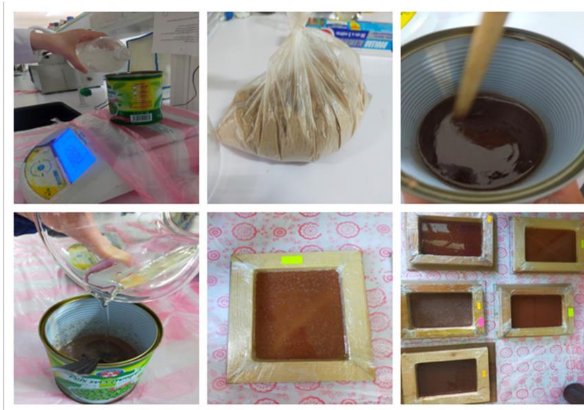
Figure II.5: Etapes de préparation des composites.
