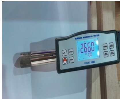
الشكل 21.III. عملية قياس الخشونة على إحدى العينات
