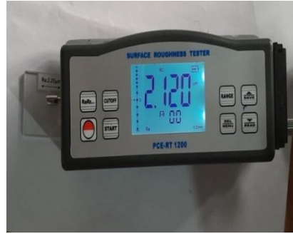
الشكل 19.III. عملية التحقق من صلاحية جهاز قياس الخشونة.
