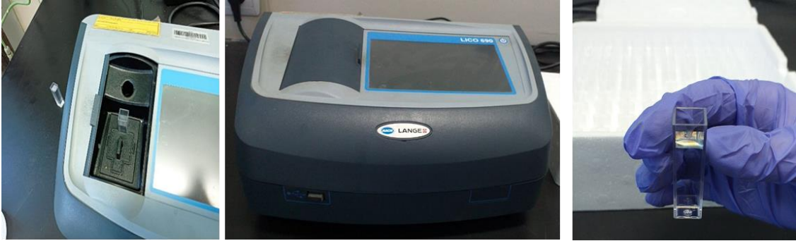
الشكل 10: جهاز تحديد اللون Saybolt Chromometer
