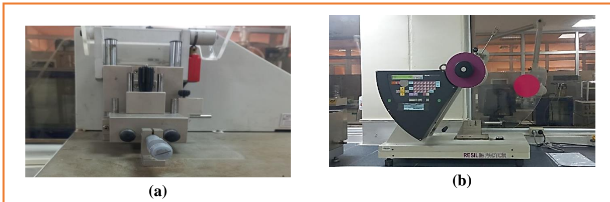
Figure 2.6 : (a) photographie de la machine d'entaille ; (b) photographie de l'appareil de l'impact.
