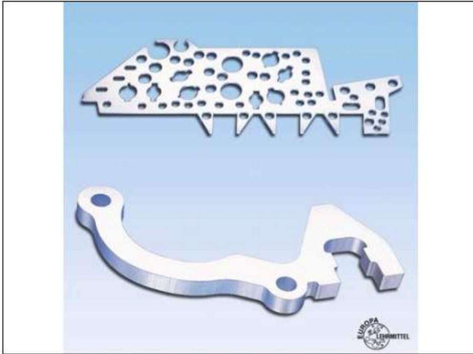
الشكل XIII. 3: أمثلة لقطع شغل أنتجت عبر التشغيل بالليزر
