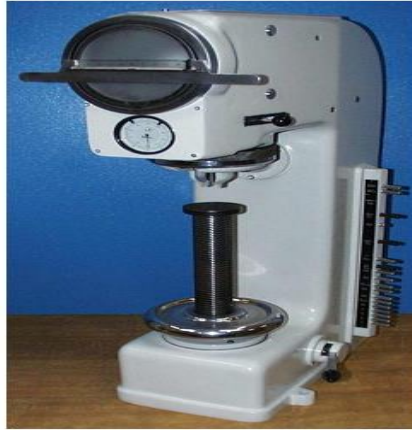
Figure IX.8. Machine d'essai de dureté.
